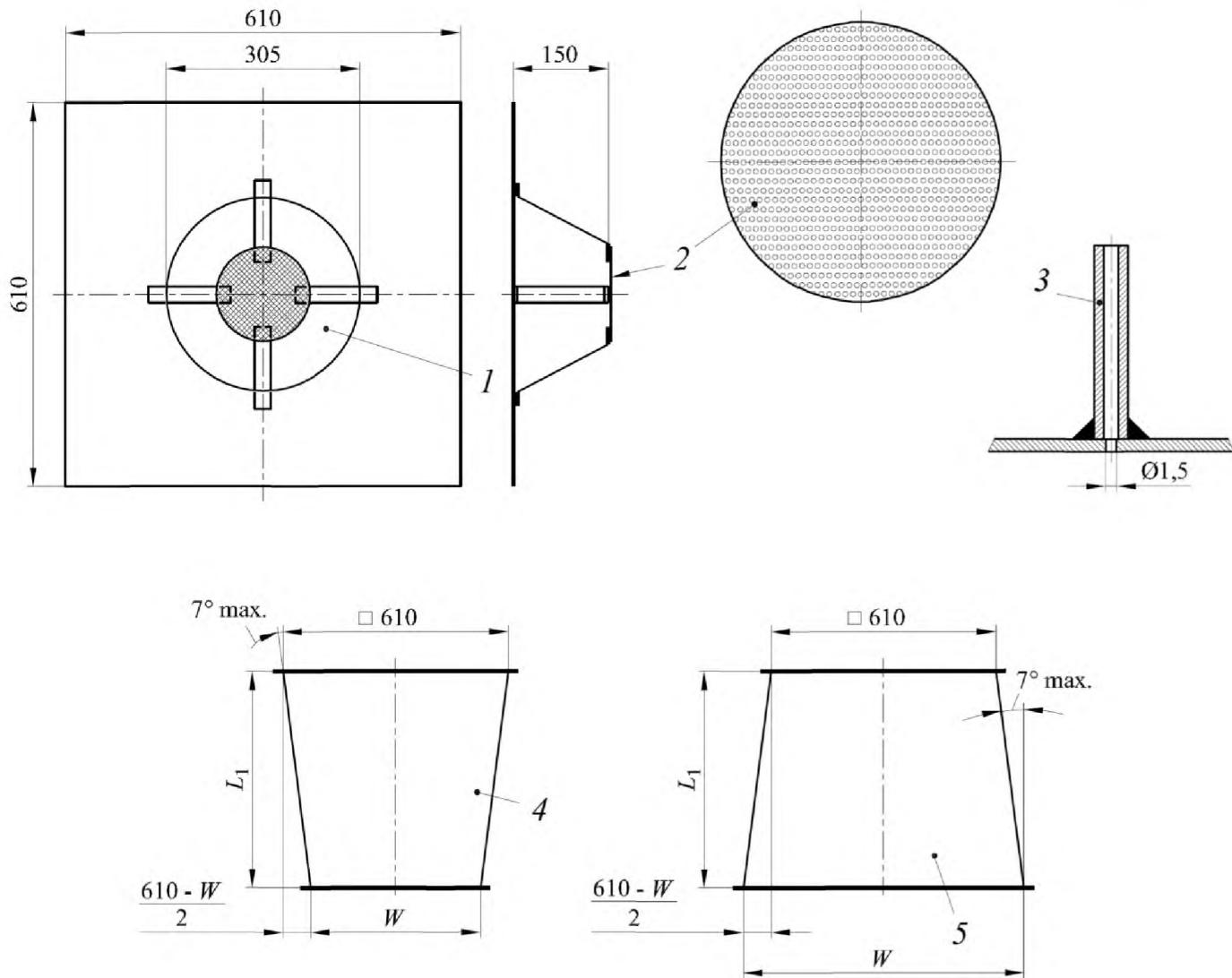
1 — смещающее отверстие; 2 — перфорированная пластина  $\varnothing 152 \pm 2$  мм, отверстия занимают 40 % площади;
