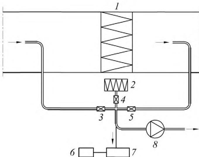
1 — фильтр; 2 — НЕРА фильтр (чистый воздух); 3 — клапан до фильтра; 4 — клапан чистого воздуха;
