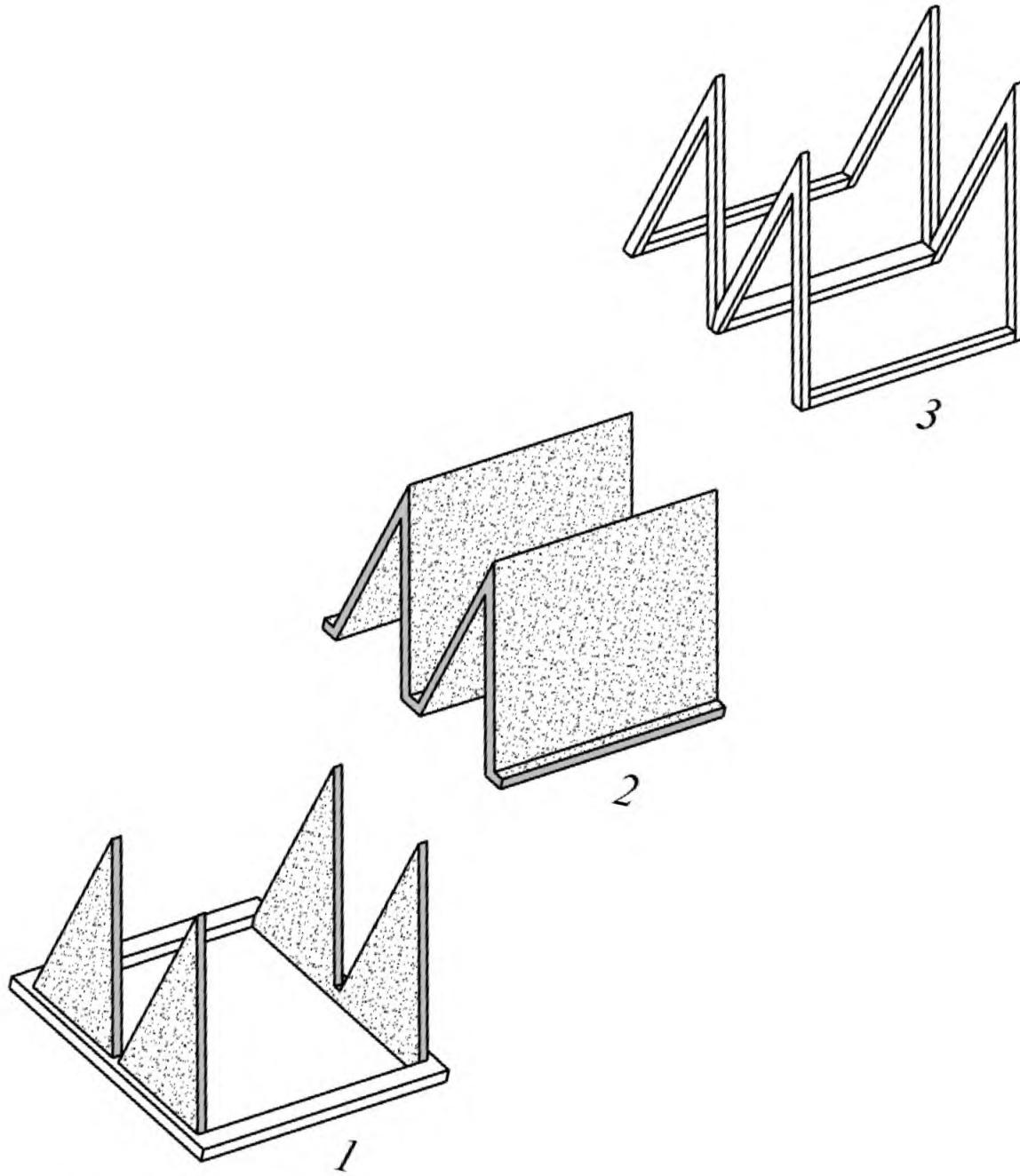
1 — рамка W-формы; 2 — фильтрующий материал ( $1 \text{ м}^3$ ); 3 — прижимная рамка W-формы
