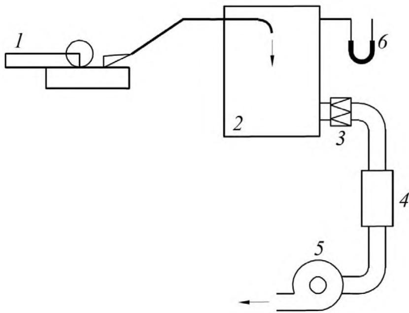
1 — генератор пыли; 2 — емкость объемом не менее  $0,25 \text{ м}^3$ ; 3 — НЕРА фильтр; 4 — устройство, измеряющее расход воздуха;
