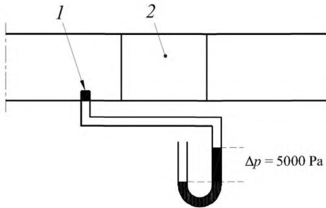
1 — заглушка для измерения давления; 2 — секция испытательного устройства
