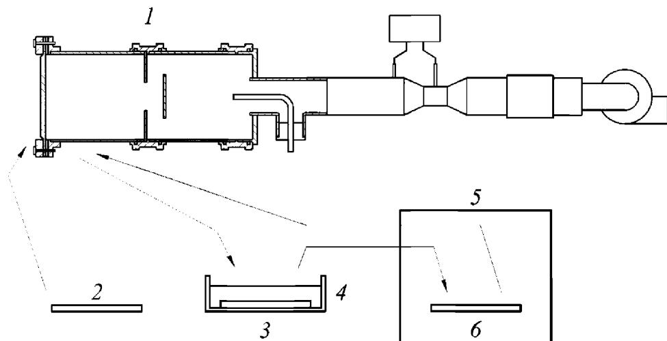
1 — устройство для определения эффективности; 2 — образец фильтрующего материала; 3 — обработка изопропанолом;
